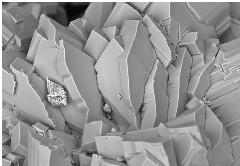
Obr. 14 Srostlice krystalů chabazitu-Ca z Tachovského vrchu; šířka záběru 240 \mu\text{m} . BSE foto L. Váchová.
