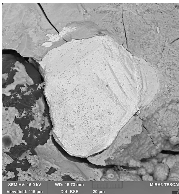
Obr. 3 Plíšek zlata (světle šedý) v křemenné žilovině, Vysoká u Havlíčkova Brodu; BSE foto O. Pour.
