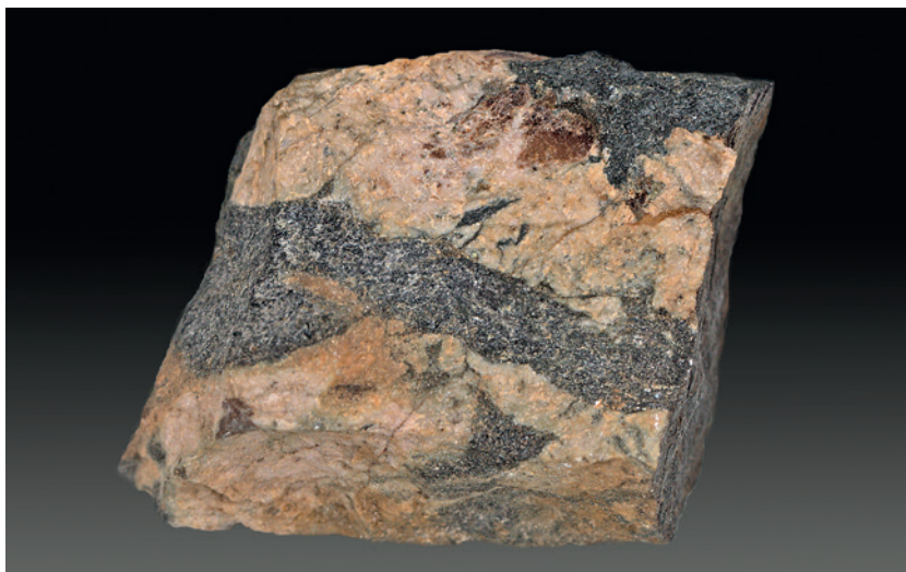
Obr. 2 Celkový záběr studovaného vzorku o velikosti 5 × 4 cm, tmavé agregáty celsianu srůstajícího s amfiboly, spessartinem a pyritem v růžovém až šedorůžovém karbonátu (rodochrozit až siderit), lom Chvaletice - západ. Foto B. Bureš.
