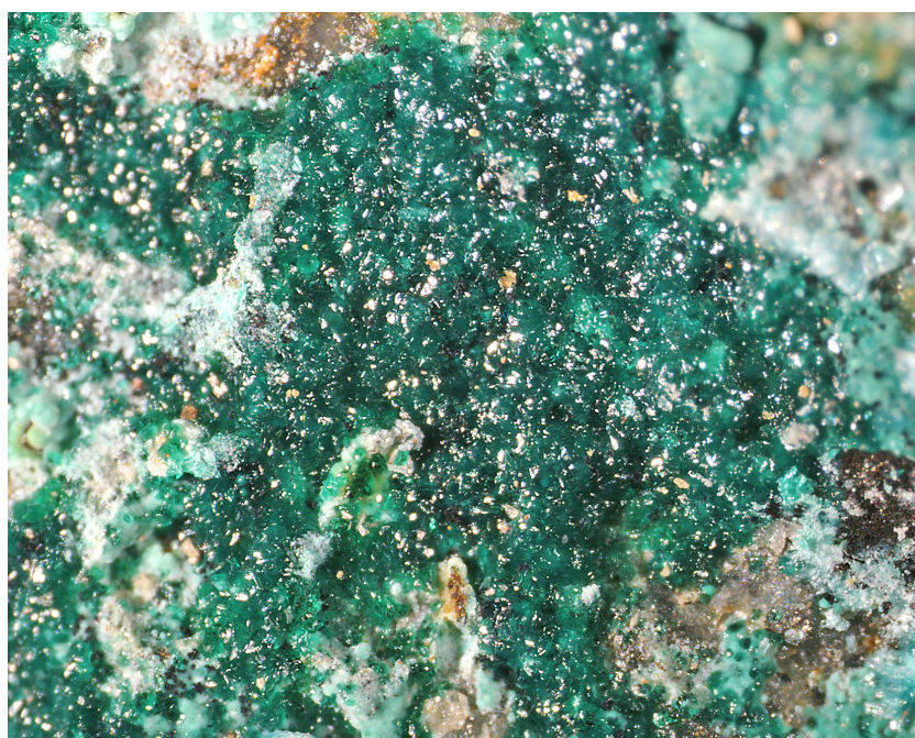
Obr. 22 Tmavě zelené, drobně krystalické agregáty brochantitu narůstající na alterované hornině v asociaci se světle modrozelenými povlaky devillinu; Krupka-Preis-selberg; šířka záběru 4 mm, foto J. Sejkora.
