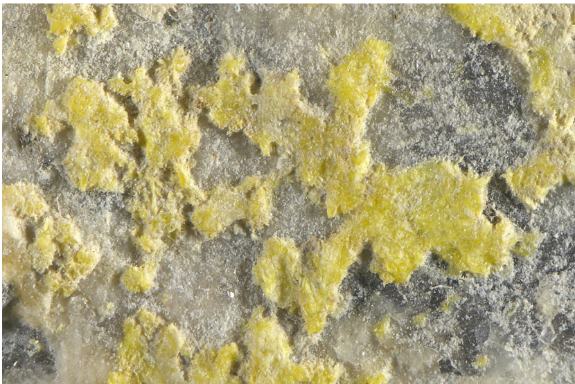
Obr. 7 Celistvé až krystalické povlaky uranofánu-beta na trhlině granitu, šířka záběru 12 mm, foto J. Sejkora.
