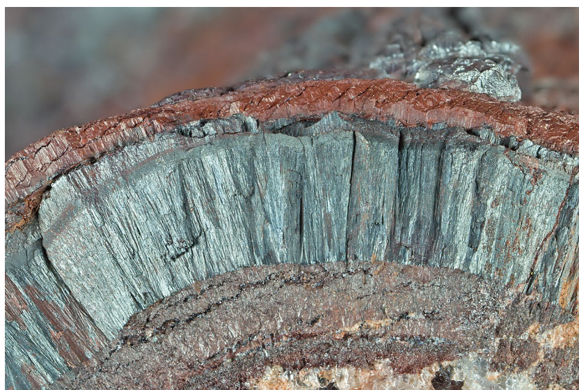
Obr. 11 Zrno pyritu (žlutavě bílé) zatlačované tzv. „half bornitem“ (hnědavý) uzavírající zrna bornitu (nařialově hnědá) lemovaná anilitem (různé odstíny modré), Horní Halže; šířka záběru 1500 \mu\text{m} , foto v odraženém světle (jeden nikol) Z. Dolníček.
