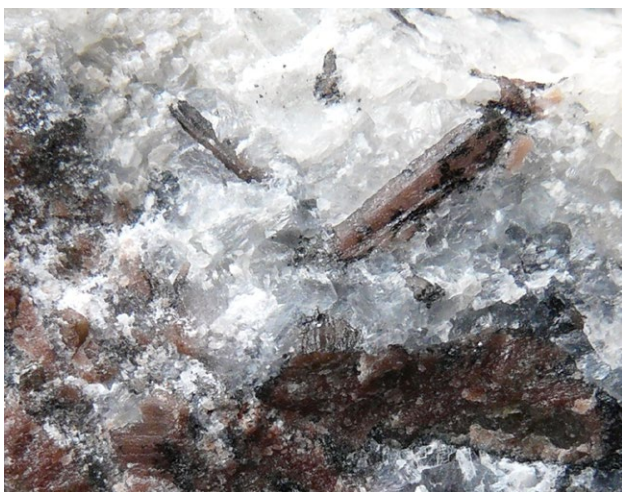
Obr. 3 Vzorek BD345. Červenavý prizmatický útvar dlouhý 8 mm, tvořený granát-anortitovým symplektitem, avšak s prizmatickým omezením původního epidotu, je obklopený bílým kalcitem. Granulární mozaika symplektitu je odkrytá při dolním okraji. Foto S. Vrána.
