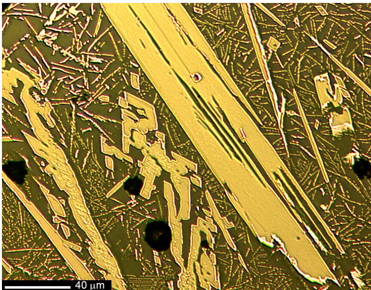
Obr. 6 Zrno Cr-spinelu s patrným reakčním lemem ve sklovité tavenině s lištami ilmenitu. Sn-struska - vzorek č. 200. Odražené světlo, foto B. Šreinová.
