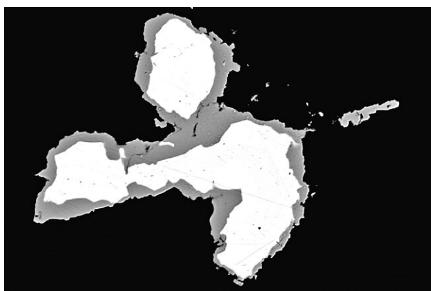
Obr. 6 Agregáty bismutu (bílé) zatlačované matilditem (šedý); Příbram - Brod; šířka záběru 180 \mu\text{m} , BSE foto J. Sejkora.
