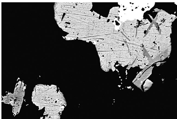
Obr. 10 Tabulkovité krystaly polybazitu (tmavěji šedý) zarůstající do agregátu akantitu (světleji šedý) srůstajícího s matilditem (bílý); v levé spodní části obrázku vystupuje srostlice tabulkovitých krystalů pearceitu (tmavě šedý); Příbram - Brod; šířka záběru 320 \mu\text{m} , BSE foto J. Sejkora.
