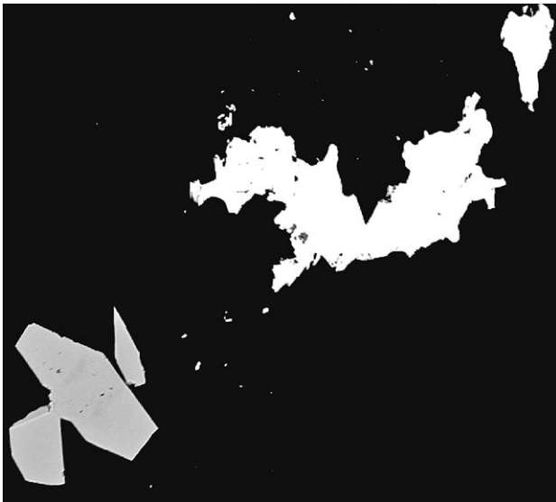
Obr. 10 Nepravidelná zrna berthieritu (světlé) a idiomorfická zrna arsenopyritu (šedé) v křemeni; Chříč; šířka obrázku 0.8 mm; BSE foto Z. Dolníček.
