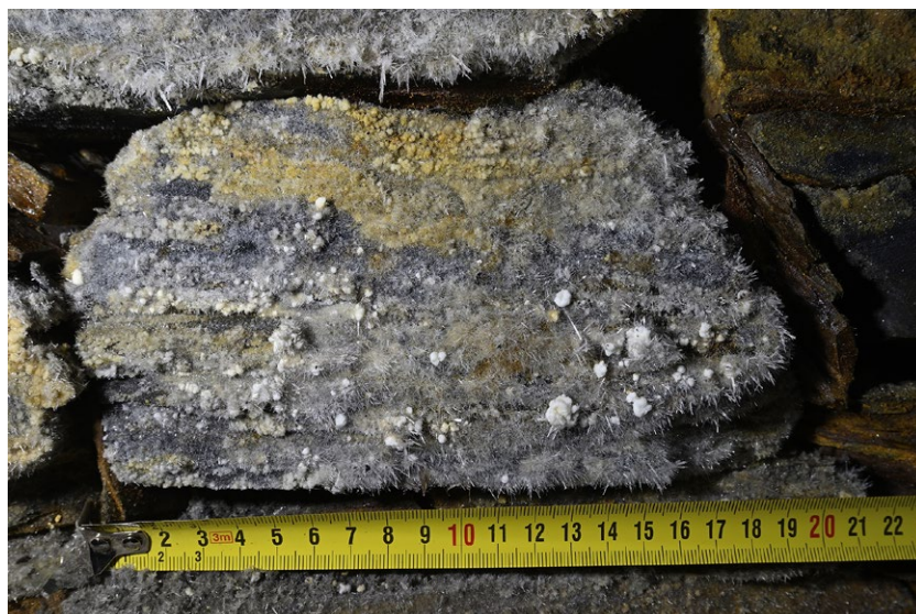
Obr. 9 Blok s povlaky jehlicovitého sádrovce a agregáty bílého aluminitu ve stěně základky. Foto M. Přibíl, 2018.
