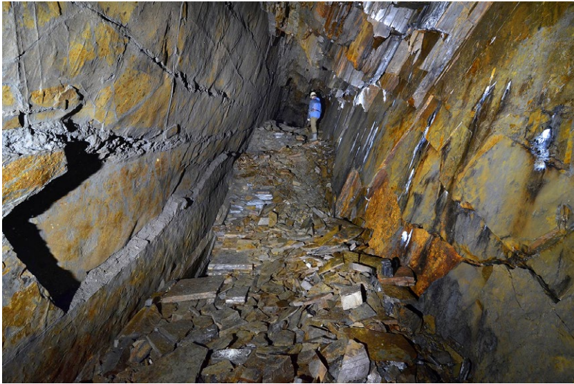
Obr. 5 Výstupek dobývky na 4. ložiskovém pruhu. Na západní straně (zde nalevo) je patrná sekundární mineralizace. Hloubka pod povrchem cca 30-35 m. Většina popisovaných minerálů však pochází ze štolového patra pod touto komorou a vzniká oxidací pyritu v rozvolněném materiálu zakládky (zde dno komory). Foto K. Šmehil, 2015.
