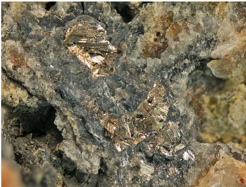
Obr. 5 Štěpné agregáty bismutu v křemenné žilovině, Přísečnice; šířka záběru 3 mm; foto P. Fuchs.
