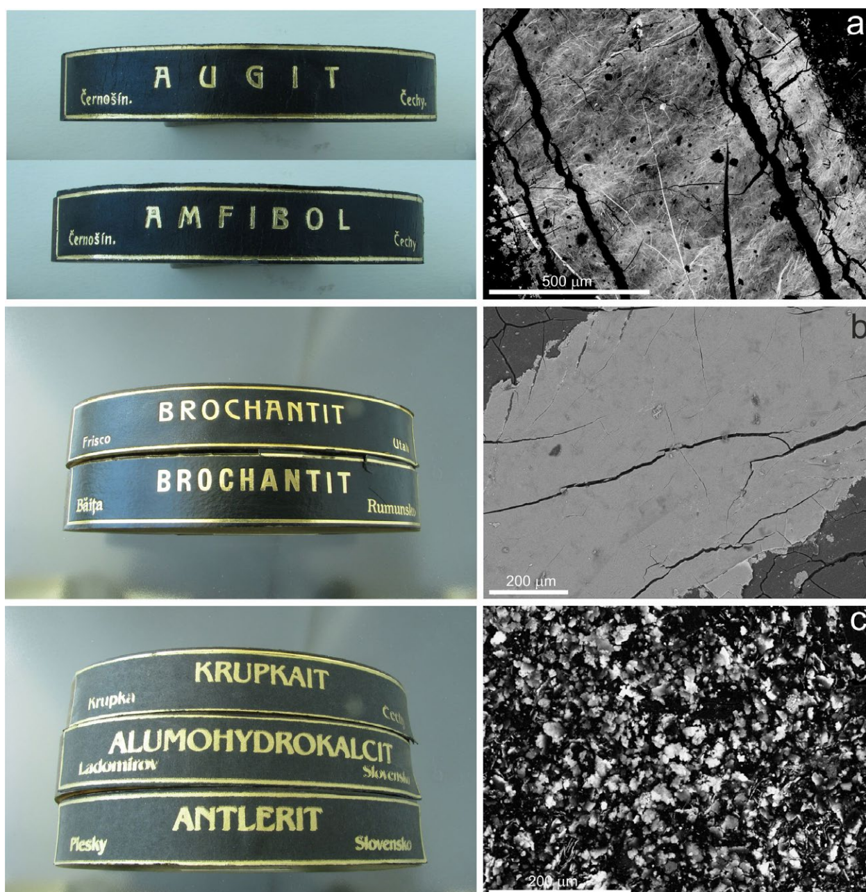
Obr. 1 Vzhled různě starých štítků na podstavečích minerálů z historické mineralogické expozice Národního muzea (snímky vlevo) a textura barvy zlatého písma v obraze BSE (snímky vpravo). Šířka podstavečků je 11 cm, výška 1.5 cm. a - nejstarší, b - 30. léta, c - 80. léta. Snímky podstavečků D. Velebil, BSE snímky Z. Dolníček.
