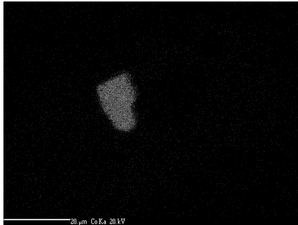
Obr. 5 Rtg. kompozičná mapa Co (Ka). Svetlý zhluk poukazuje na prítomnosť kobaltpentlanditu. Foto D. Ozdín.
