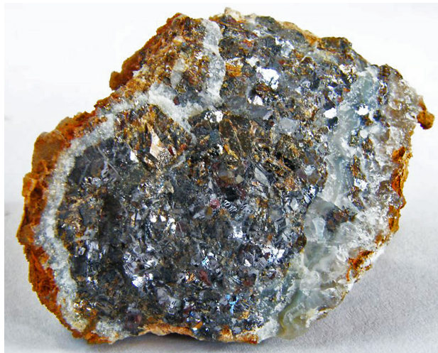
Obr. 4 Zrnité agregáty sfaleritu a galenitu z Helenína, velikost vzorku 7 cm. Foto S. Kopecký.
