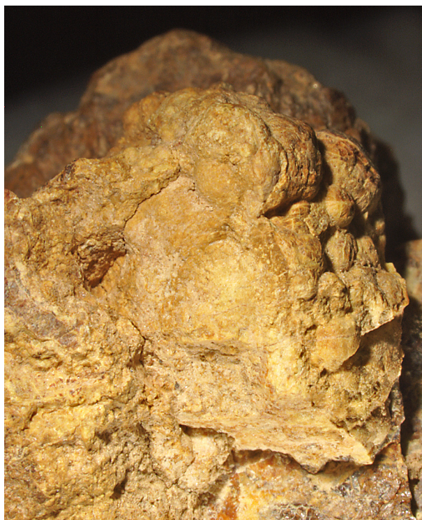
Obr. 7 Pseudomorfózy žlutého kasolitu po polokulovitých agregátech uraninitu, Zborovy - Nicov. Šířka obrázku 1 cm, foto J. Sejkora.
