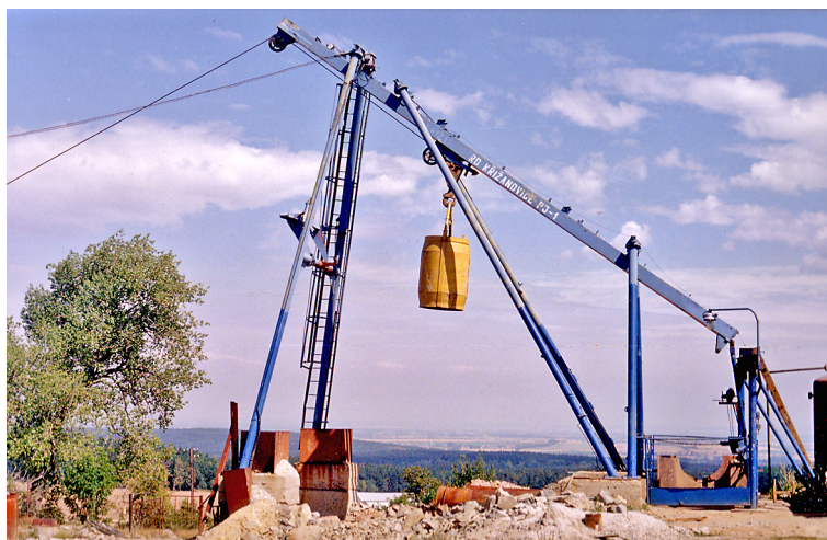
Obr. 2 Těžní zařízení (tzv. kudlanka) na průzkumné jámě PJ-1 Křižanovice. Foto archiv RD Kutná Hora, konec osmdesátých let minulého století.
