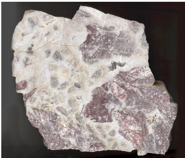
Obr. 2 Chaotická textura křemenné žily č. 1. Spodní délka obrázku 18 cm. Makrofoto P. Gadas.
