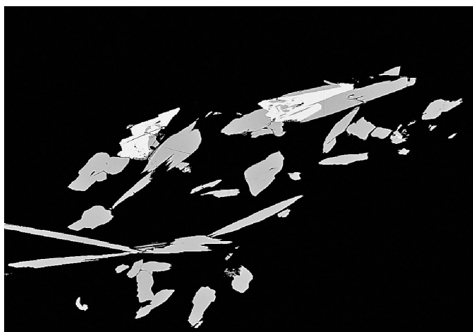
Obr. 7 Agregáty galenitu (bílý) srůstající s jehlicovitými krystaly boulangeritu (šedý) Čistá; šířka obrázku 1200 \mu\text{m} ; BSE foto J. Sejkora.
