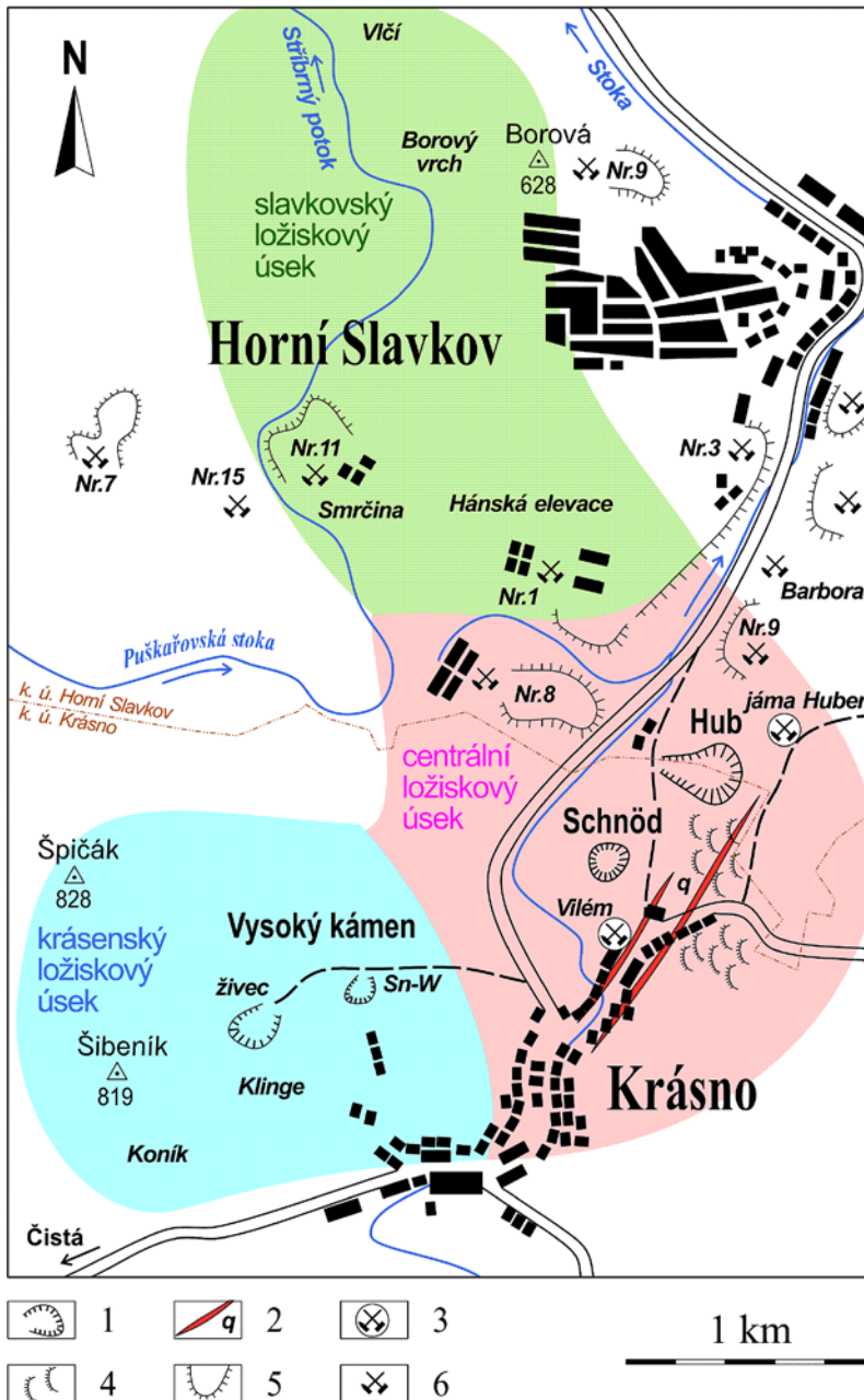
Obr. 1 Mapa rudního revíru Krásno-Horní Slavkov. 1 lom, propadlina, 2 křemenné žíly systému Gellnauer, 3 Sn-W jámy, 4 středověké haldy, 5 haldy uranových dolů, 6 uranové šachty. Zpracoval J. Tvrđý 2008.
