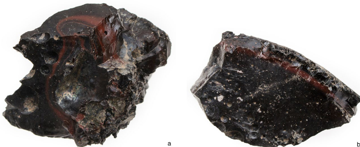
Obr. 4ab Tmavá sklovitá struska s fluidální texturou zvýrazněnou červenými smouhami, délka vzorku a 5 cm, vzorku b 5.5 cm. Foto P. Šeplavý.
