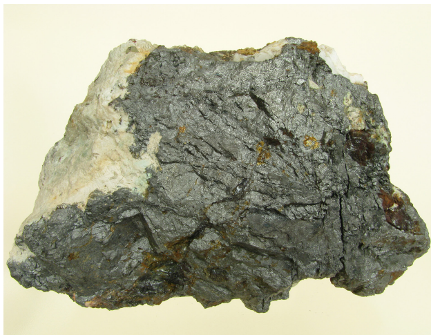
Obr. 2 Tetradrit z Rožňavy na Slovensku obsahující více než 17 hm. % rtuťi (D18, Národní muzeum P1N 33538); masivní agregát velikosti 11 × 6 × 7 cm s křemenem. Foto D. Velebil.
